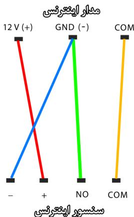
سنسورهای اینترنس را مطابق نقشه تصویر به مدار متصل نمایید. توجه: با توجه به اهمیت سنسور در حفظ امنیت درب اتوماتیک، پیشنهاد میشود از سنسور استاندارد استفاده نمایید.
