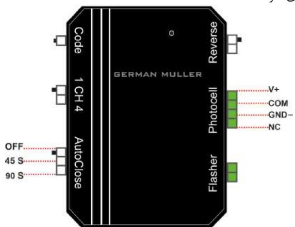
۴. چپگرد یا راستگرد (Reverse) : تنظیمات کارخانه در حالتی است که موتور در سمت راست درب نصب شود، اگر موتور در سمت چپ درب نصب شود، موقعیت این دیپ سوییچ را تغییر دهید تا دکمه‌های (بالا و پایین) ریموت بدرستی عمل کنند.
